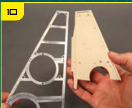
Фрагмент BP-33 монтируется на узкой части каркаса.
