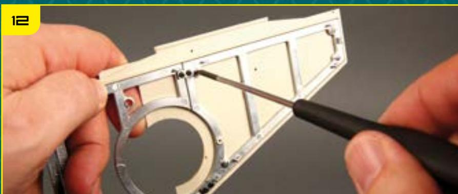
Зафиксируйте фрагмент BP-33, закрутив винты в четыре отмеченных выше штифта.
