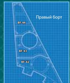
На двух небольших врезках в центральной части чертежа изображены шесть рам нижней части каркаса «жвал» и четыре крепящихся на них фрагмента обшивки. Оба жвала имеют прямоугольные выступы, крепящиеся к основной части каркаса модели. Каждая рама каркаса имеет маркировку BF-, а фрагменты обшивки — BP-. Данная маркировка будет указываться в последующих пошаговых инструкциях.
